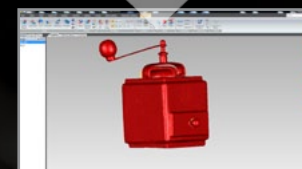
Siatka trójkątów odwzorowująca strukturę i szczegóły bryły obiektu
