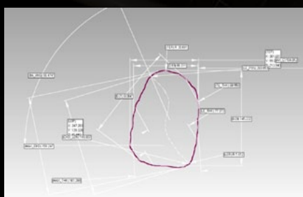
Wymiarowanie w wielu płaszczyznach
